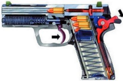
1. Pistole geladen, Sicherungshebel auf „F“, Hahn gespannt
