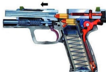
6. Verschluss im Vorlauf, Patrone wird dem Patronenlager zugeführt
